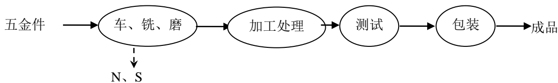
图 3-1 电子元器件、半导体元器件专用材料生产工艺流程及产污环节图
